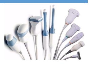
Consta de tres partes: el conector, el cable y la sonda. La diferencia entre unos tipos de transductores y otros radica fundamentalmente en las características de la sonda (superficie de contacto, disposición de los cristales), acordes al uso que se precise. La sonda en su interior contiene una serie de cristales que, gracias al efecto piezoeléctrico, generan vibraciones que se emiten como ondas de ultrasonido.
